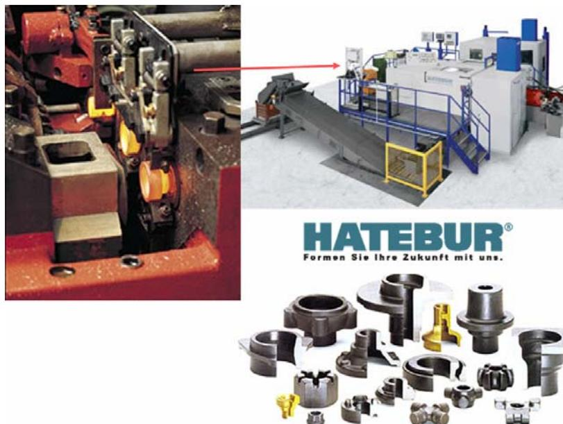
Figura 02 - Prensa horizontal utilizada na conformação a quente e exemplos de produtos obtidos
