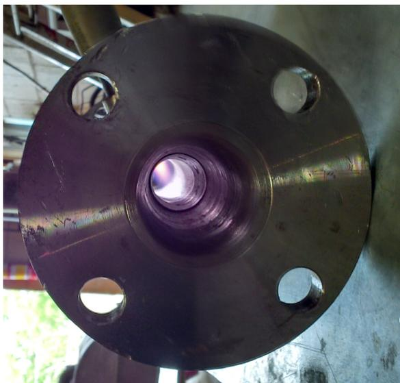
Figura 4.12: Tocha de plasma em funcionamento dentro do tubo.
