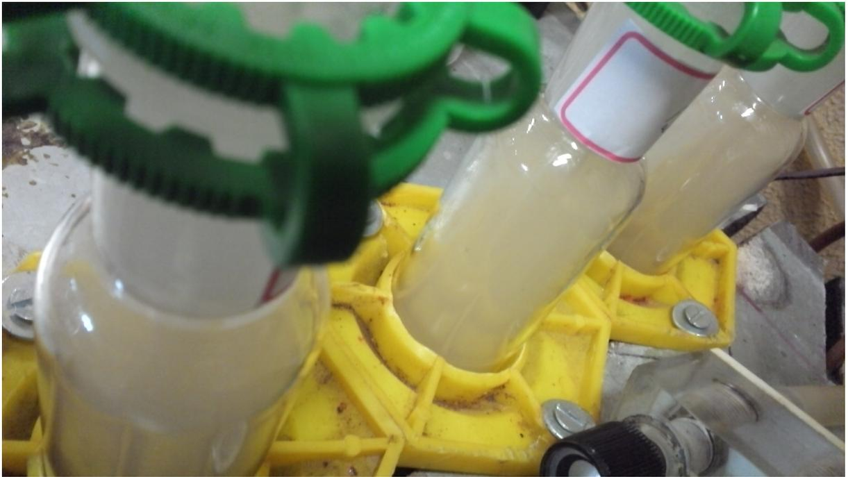
Figura 5.8: Gás de gaseificação dentro dos impingers.
