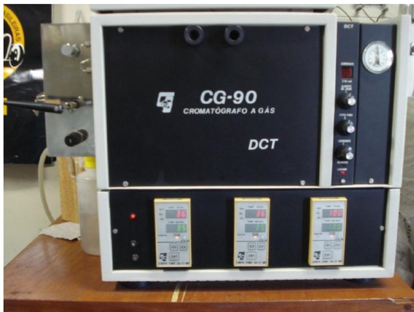
Figura 4.1: Cromatógrafo CG tipo 90.
