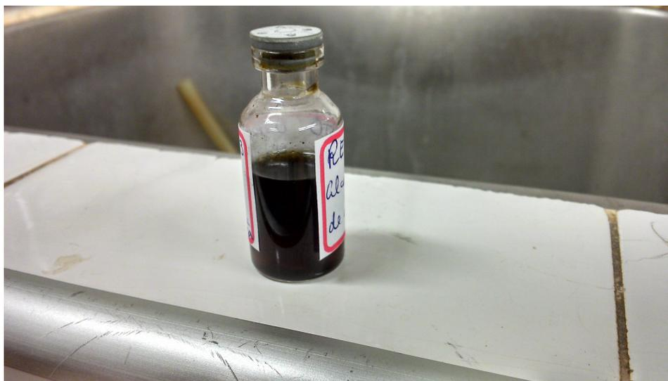
Figura 5.11: Alcatrão coletado diluído em álcool isopropílico.
