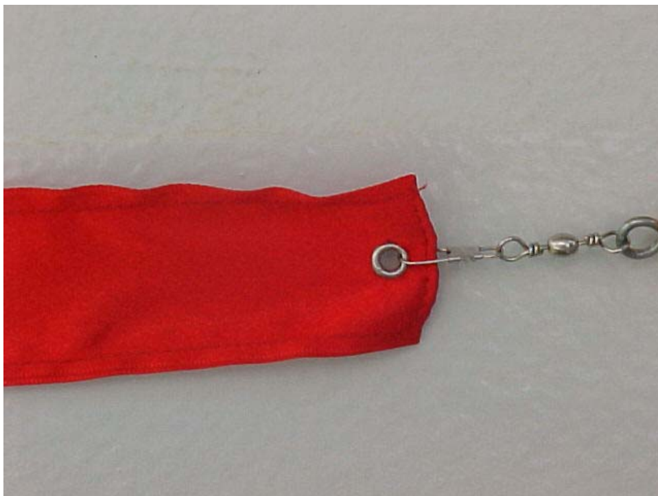
Fig. 19 – Foto de um ilhós em uma Fita e um girador preso no ilhós
