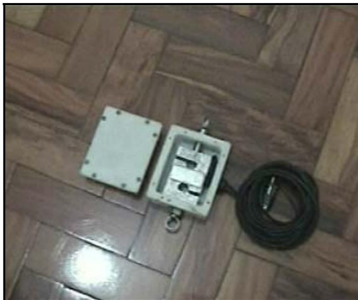
**Foto 3.2.** Transdutor de força (célula de carga)
