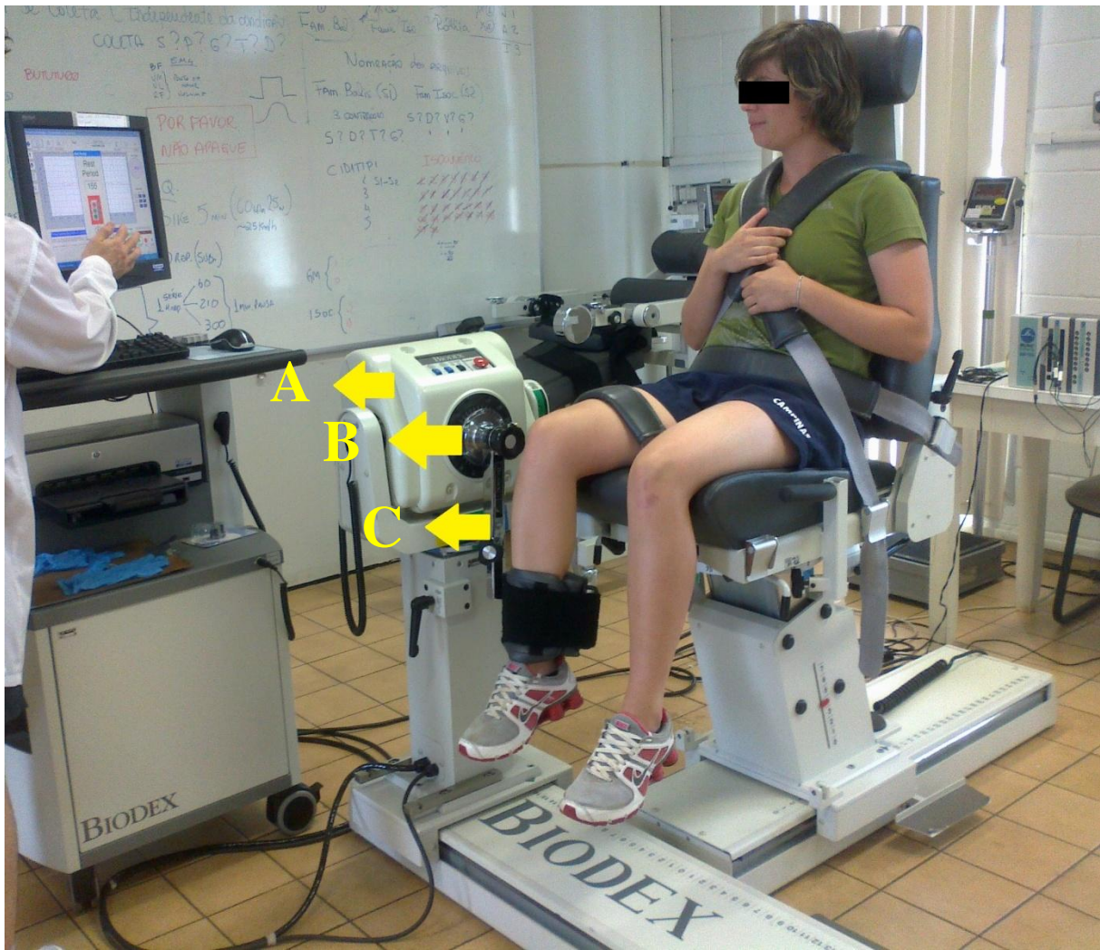
Figura 1. Exemplo de um dinamômetro isocinético. A = Braço de alavanca; B = localização da célula de carga; C = Unidade de aceitação de força.
