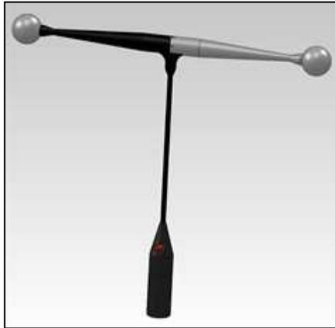
**Figura 10 – Exemplo de barra utilizada para refinamento dos parâmetros das câmeras com dois marcadores.**
