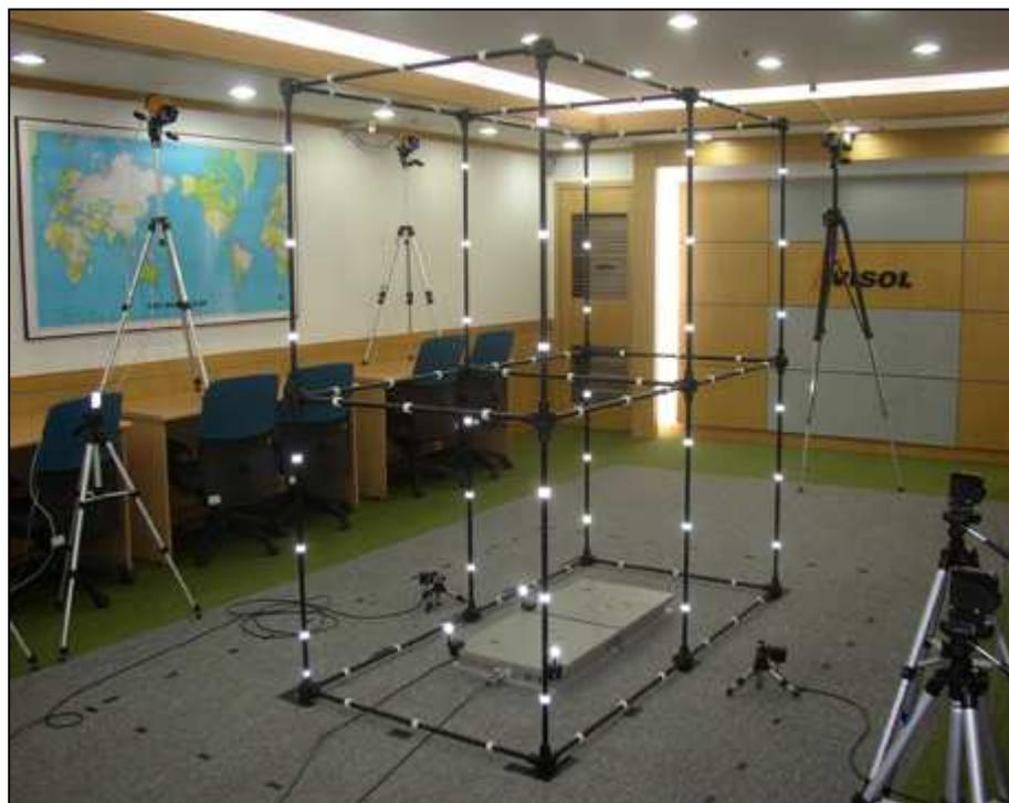
**Figura 2 - Exemplo de objeto rígido utilizado para determinação do volume de calibração, utilizada no sistema proposto por Kwon (1994).**
