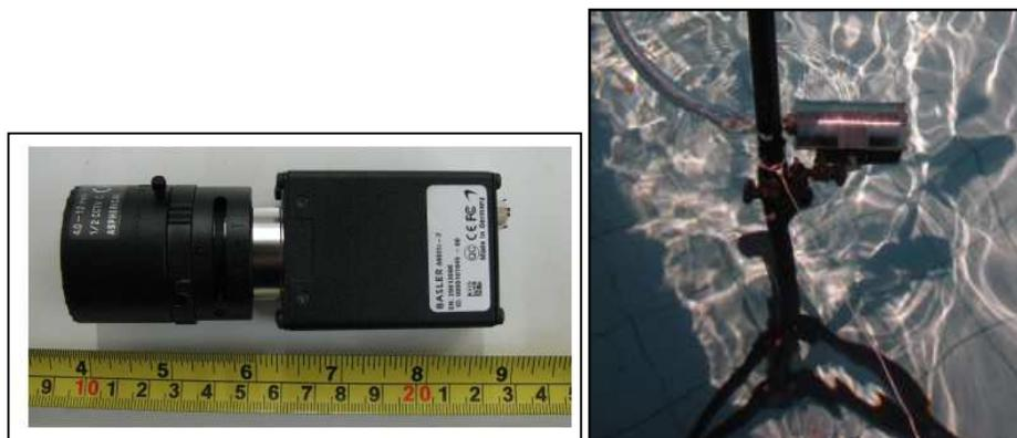
Figura 15 - Câmera Basler fc602A, utilizadas no sistema e dentro da caixa-estanque.
