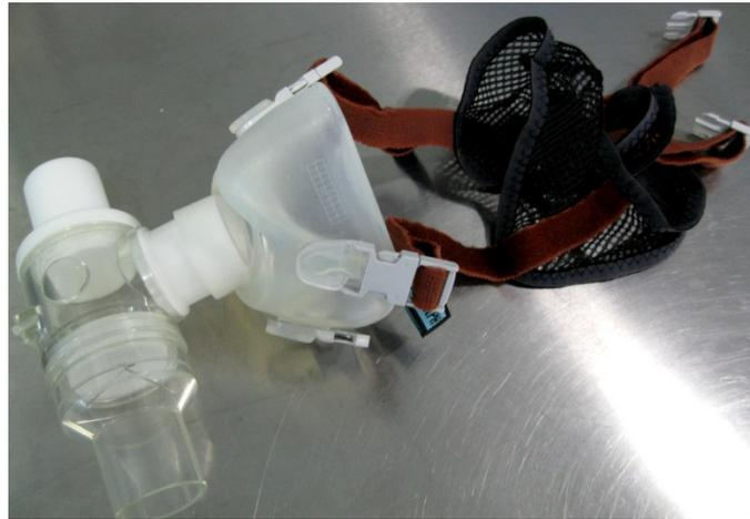
**Figura 13** – Imagem da máscara utilizada pelos participantes para respirar o ar em hipóxia vindo dos sacos de Douglas. O ar inspirado e expirado não se misturam devido a válvulas presentes na máscara.
