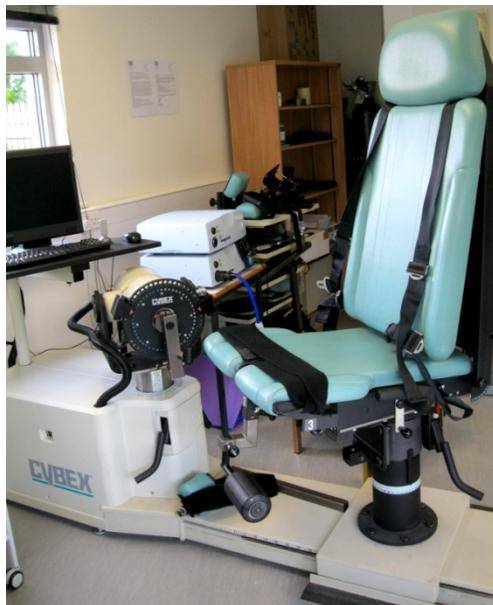
**Figura 16** – Imagem do equipamento isocinético utilizado para a avaliação neuromuscular.
