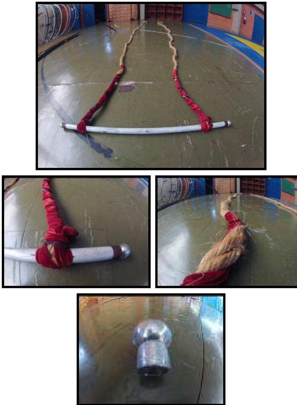
**Figura 9:** Imagens de um trapézio fixo manufacturado de modo inadequado
