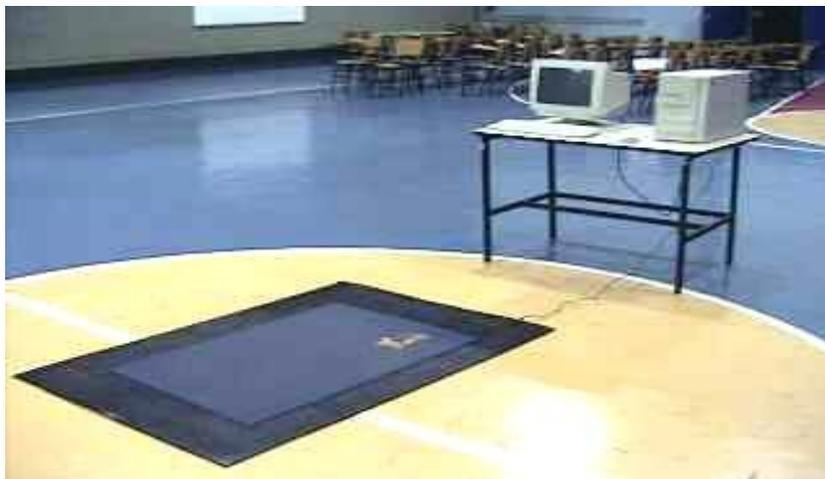
**FIGURA 2: Equipamento JUMP TEST empregado para as coleta de dados com saltos verticais.**
