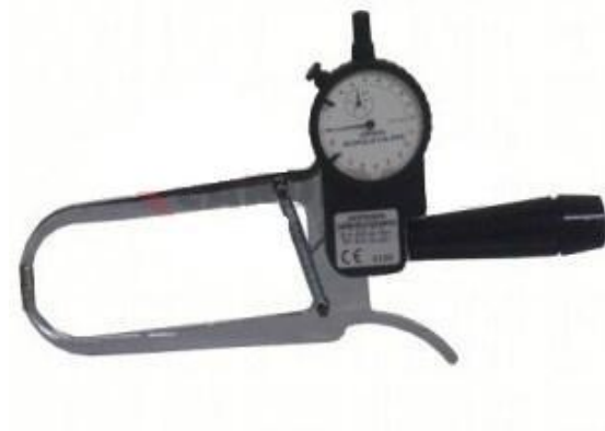
Figura 01. Adipômetro científico do tipo Harpenden com precisão de 0,2 mm.
