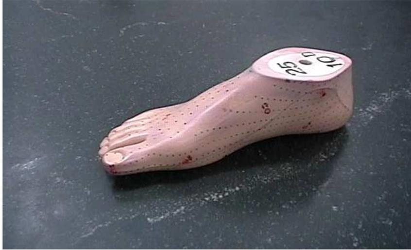
**Figura 18** – Vista medial do modelo do pé usado na aplicação da metodologia com pontos marcados sobre a superfície.
