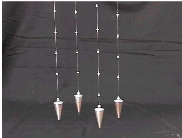
**Figura 16** – Prumos presos ao calibrador.
