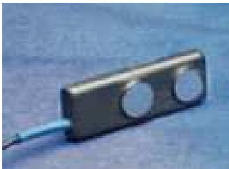
**FIGURA 5.** Eletrodos ativos da marca Biopac (Biopac Sistens, Inc. Santa Barbara, CA, USA) modelo MP150.
