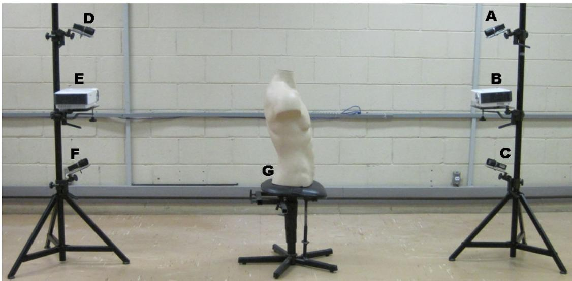
**Figura 2: Configuração experimental com o posicionamento das câmeras dos projetores e do manequim de tronco. (A) Câmera Anterior Superior (CAS); (B) Projetor Anterior; (C) Câmera Anterior Inferior; (D) Câmera Posterior Superior (CPS); (E) Projetor Posterior; (F) Câmera Posterior Inferior (CPI); (G) Manequim de tronco.**
