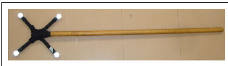
**Figura 12.** Objeto rígido utilizado para o teste de acurácia com o conjunto de câmeras 2.
