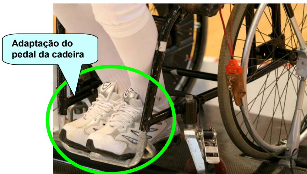
Figura 16. Adaptação realizada no pedal da cadeira a fim de adequar a lesão dos membros inferiores do esgrimista.
