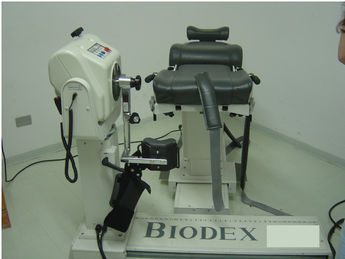
Figura 2. Dinamômetro isocinético utilizado para a mensuração do torque.
