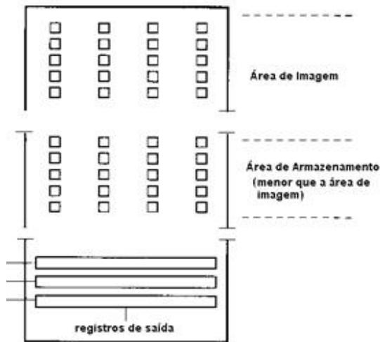
Figura 3: Esquema de funcionamento de um CCD FT (THORPE, 1997, p.26)
