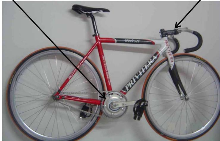
Pedivela instrumentado instalado na bicicleta
