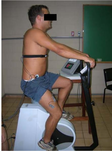
**Figura 1.** Sujeito 1 durante a realização de um dos testes no cicloergômetro de frenagem eletromagnética do modelo Corival 400, (Quinton Inc, Groningen, Holanda).
