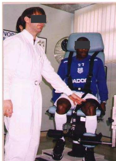
Figura 3. Posicionamento do atleta na cadeira do dinamômetro isocinético *Cybex®*.
