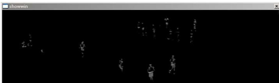
Figura 14 - Subtração do fundo do quadro atual
