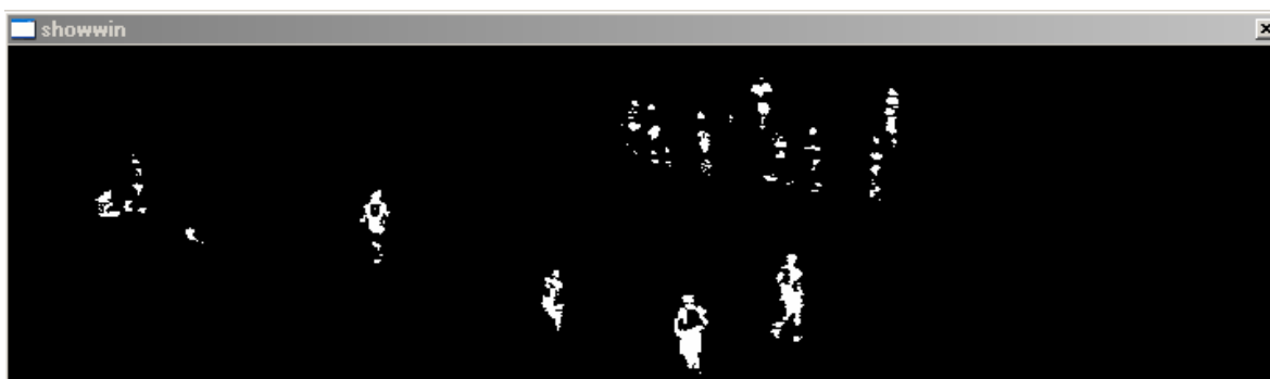
Figura 17 - Aplicação do filtro passa-alta (binarização da imagem)
