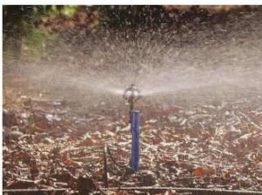
Fig. 2.7: Micro-aspersor rotativo.
