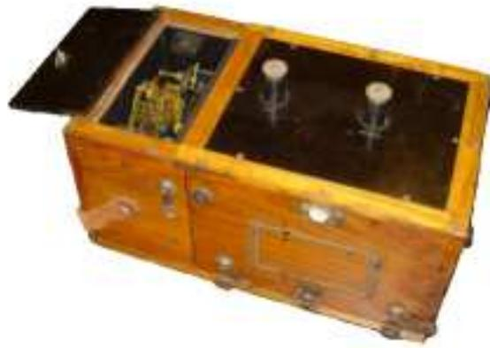
Figura 2.1: Gravador de descargas atmosféricas, desenvolvido pela GE na década de 1920.
