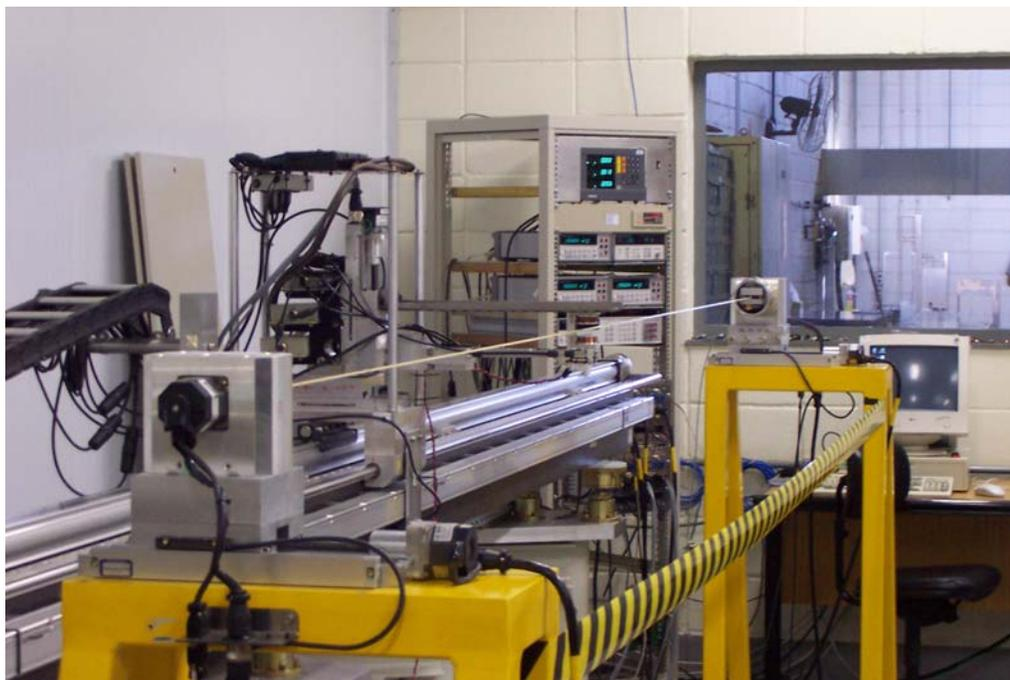
*Figura VII.1. Bobina girante e seus acionadores mecânicos em evidência.*
