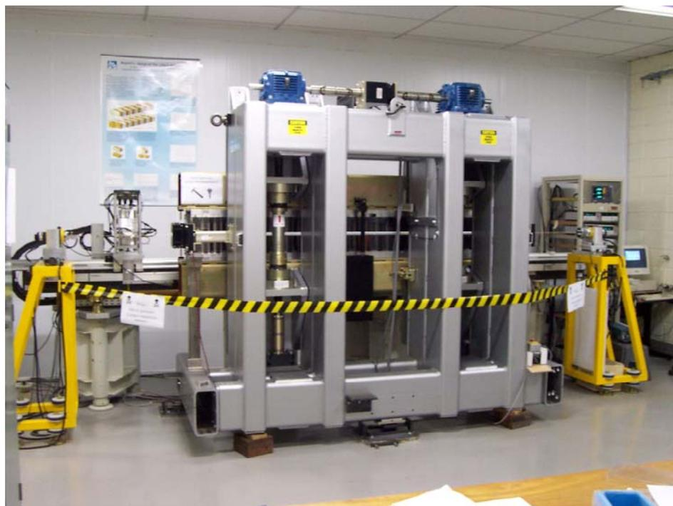
Figura VI.1. Foto do “wiggler” na bancada de caracterização – prédio de Ímãs – sala 26.
