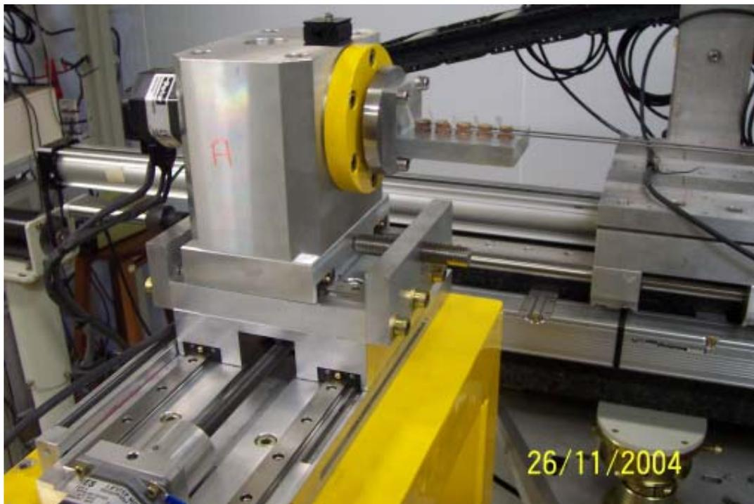
*Figura VII.11. Extremidade utilizada para esticar os fios. A outra extremidade contém o conjunto de molas e a escala para a medida da força.*
