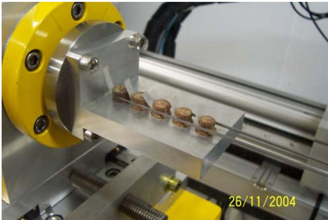
*Figura VII.9. Vista dos espaçadores/estiradores dos fios de tungstênio. Estes espaçadores são feitos de celeron.*
