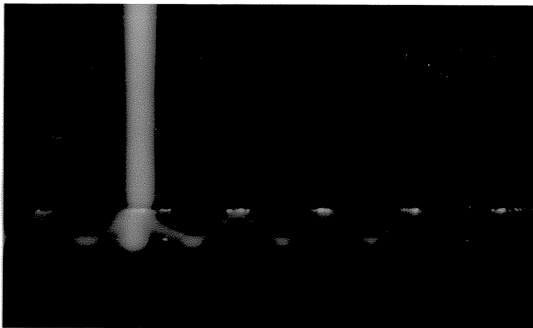
Fig.4.9)- Acoplamento holográfico em lâmina de sílica vítrea. Componente gravado com os seguintes parâmetros experimentais: \theta = 63^\circ , \lambda_i = 514,5 \text{ nm} , \lambda_g = 457,9 \text{ nm} , h = 1,65 \text{ nm} , n_v = 1,51 , .
