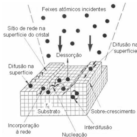
Fig. 1.2: Fenômenos que ocorrem na superfície do substrato durante um típico crescimento por MBE. (Ref. [7])
