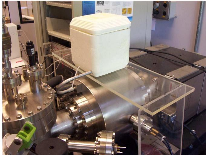
Fig. 1.8: Bomba de Sublimação de Ti conectada à câmara de MBE.
