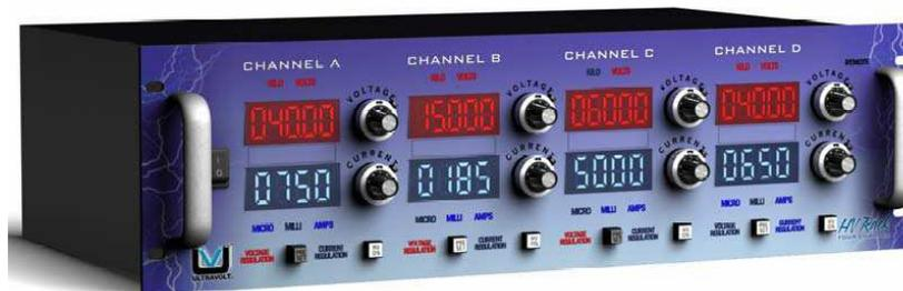
Fig. 2.12: Fontes de alta tensão utilizadas para polarizar os cadinhos das evaporadoras.
