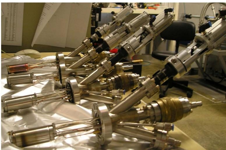
Fig. 2.8: Evaporadoras por feixe de elétrons construídas neste trabalho.
