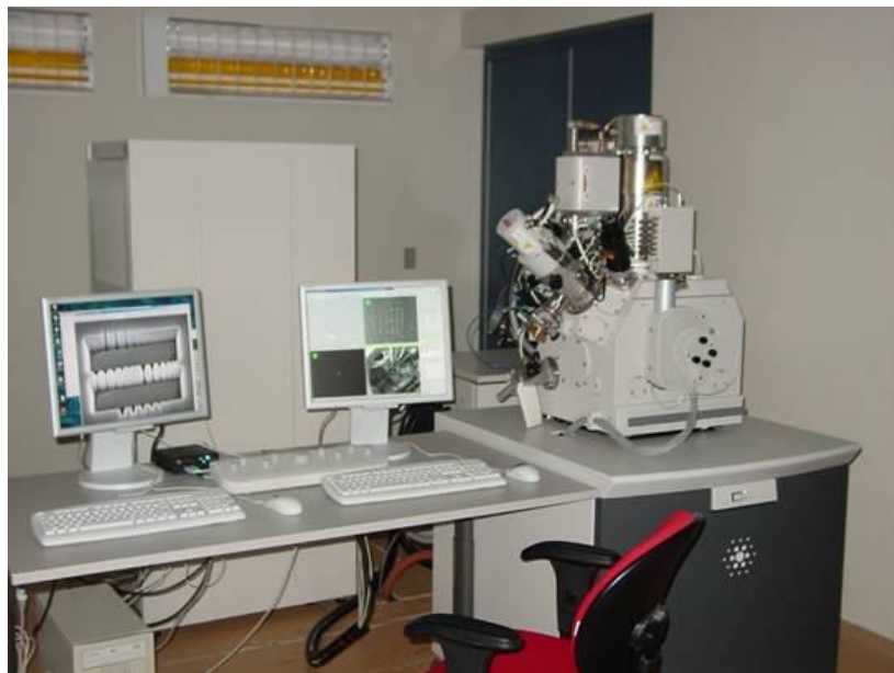
Figura 3.6: Dual-Beam system modelo NOVA 200 Nanolab da FEI Co.
