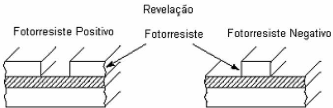
Figura 2.2 O filme de fotorresiste positivo e negativo após exposição e revelação [11].
