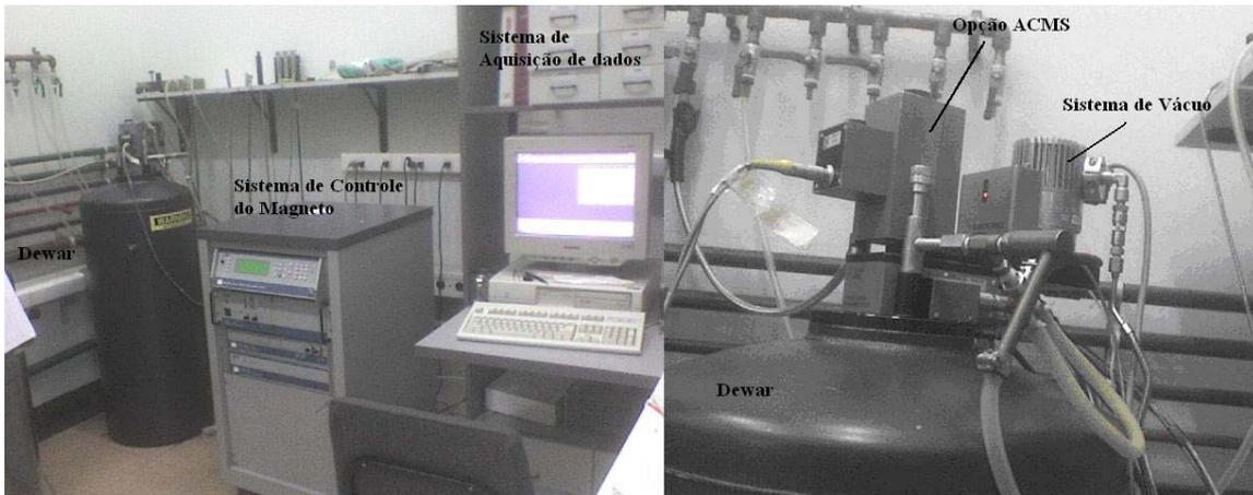
Figura 27 – Foto do sistema PPMS onde foram realizadas as medidas de M-DC.
