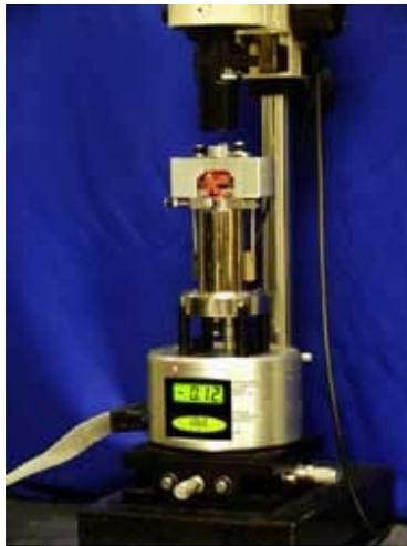
**Figura 23 – Multimode Scanning Probe Microscope utilizado nas imagens de AFM e MFM.**
