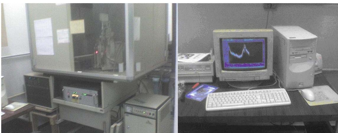
Figura 25 – Difratômetro de Raios –X. À esquerda, a câmara do sistema, à direita, o sistema de aquisição de dados.
