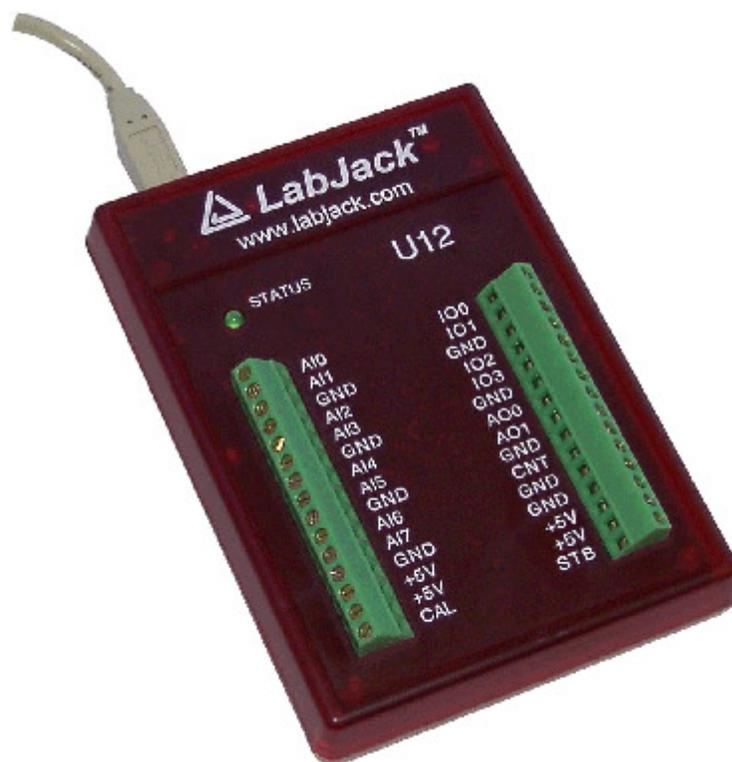
Fig. 3.7: Placa de aquisição de dados.
