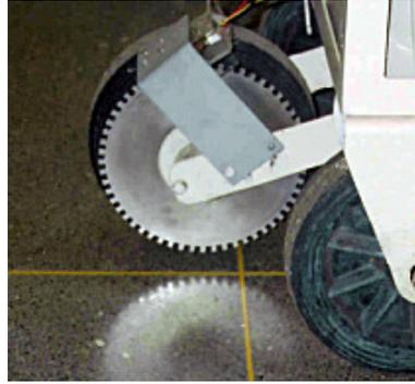
Fig. 3.6: Detalhe do amostrador espacial (roda dentada + circuito amostrador).
