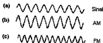
Figura 2.3: a) Sinal modulante; b) Modulação AM; c) Modulação FM (modificado de Mackay, 1995).
