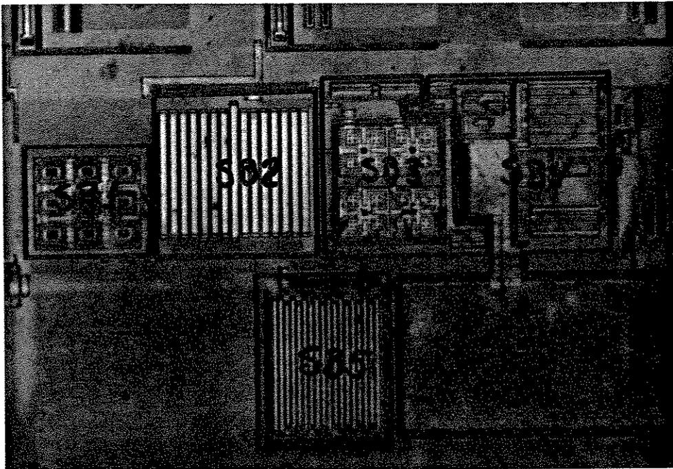
Foto 1.3 - Detalhe da fonte de tensão de referência com subdivisões para extração do circuito.
