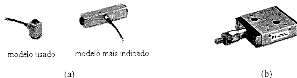
Figura 4.23 – (a) Dois atuadores PZT: o empregado, que não impõe à grade uma sintonia superior a cerca de 5 pm, e um mais indicado (mais camadas cerâmicas); (b) microposicionador linear foi adicionado à montagem de sintonia mecânica.
