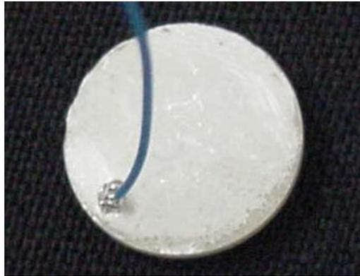
Figura III.2. Fio soldado perpendicularmente à face da cerâmica.
