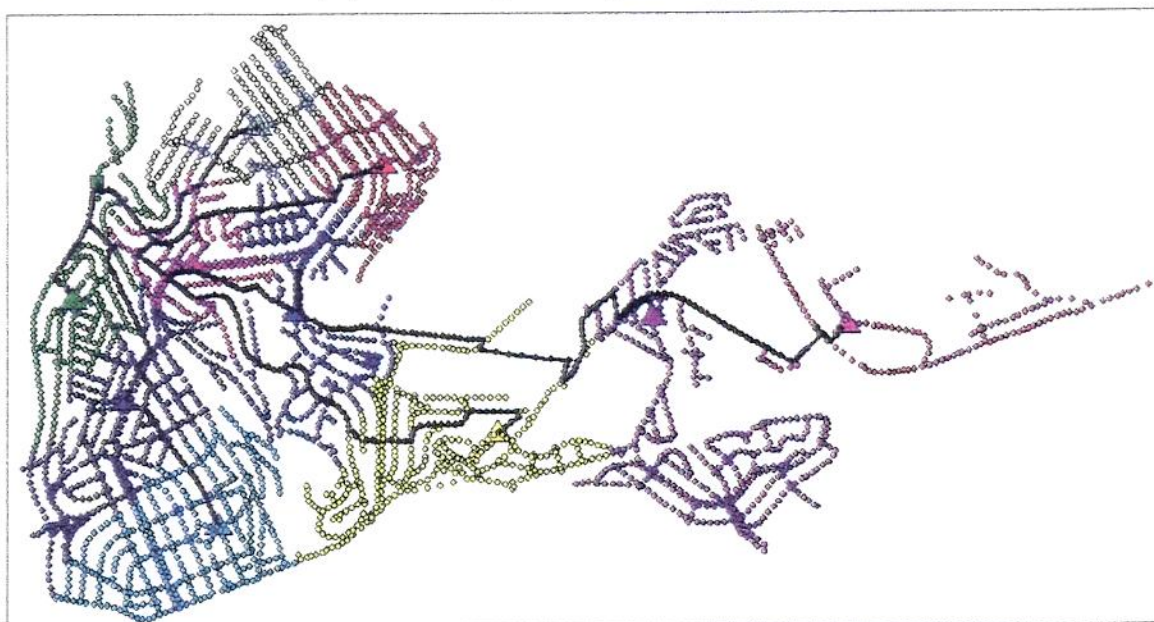
Figura 5.3 – Rede primária do projeto inicial sem melhoria para 10 armários.
