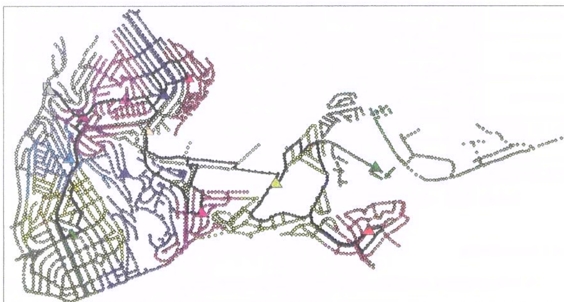
Figura 5.28 – Reprojeto 14 armários – ROP subterrânea e aérea (anel).
