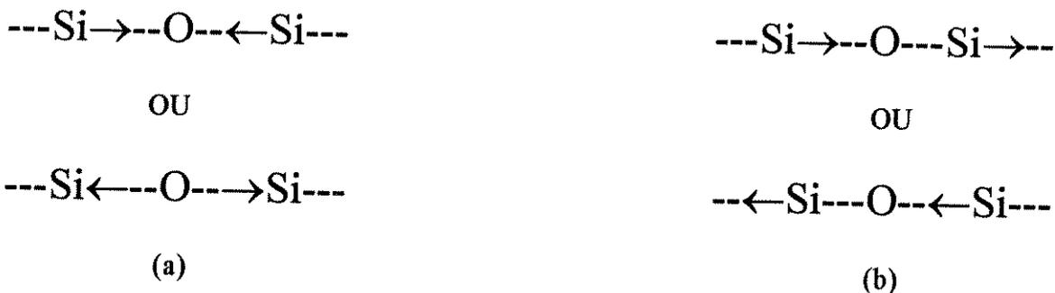
Figura D.2- (a) estiramento simétrico; (b)- estiramento assimétrico.
