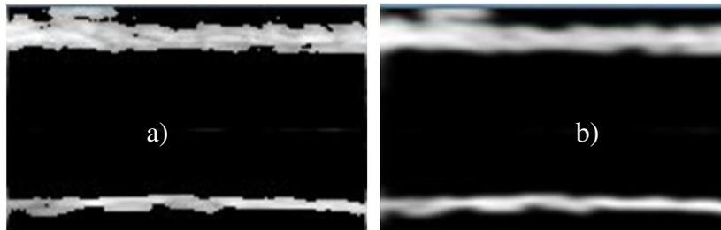
Figura 28 - Imagem resultante da aplicação do filtro gaussiano anisotrópico (b) sobre a imagem gerada pelo processo de erosão das regiões proximal e distal (a).
