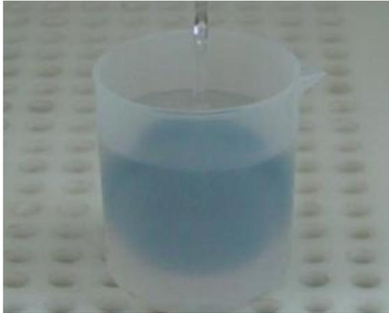
Figura 1.6 - Foto da etapa de remoção do fotoresiste para proteção do filme crescido.
