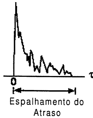
Fig. 1.3: Resposta impulsiva ilustrando o conceito do espalhamento do atraso
