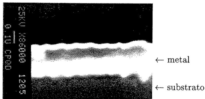
Figura 4.36: Secção transversal de um contato Ni/Ge/Au/Ni/Au em GaAs dopado com Si, após tratamento para liga a  $455^\circ\text{C}$ , por 30" em RTA.  $86.000\times$ .
