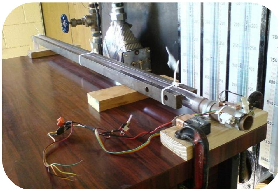
**Figura 3-8: Cano de laminação de escoamento** – o cano que precede o experimento é reto e possui um comprimento maior que trinta vezes o diâmetro interno do cano do experimento. Esse cano que precede o dispositivo proposto foi utilizado para minimizar as influências de turbulências nos testes.
