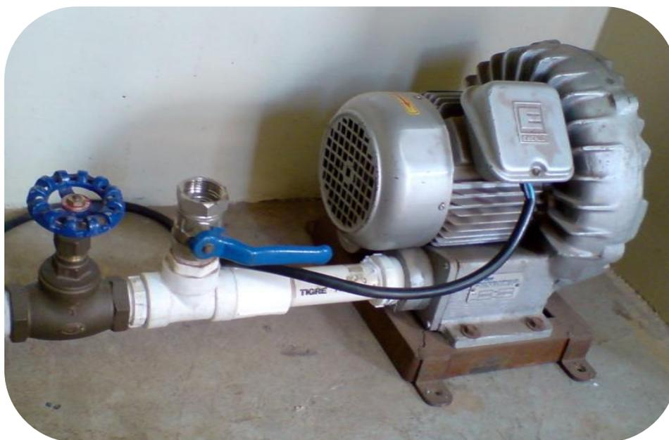
**Figura 3-10: Compressor industrial usado nos testes** – compressor de ar da marca Ibram modelo CR-2 com capacidade máxima nominal de 0.8 metros cúbicos por minuto (13.33/s) e válvulas utilizadas para alterar a velocidade do regime de escoamento que chega até o dispositivo proposto.
