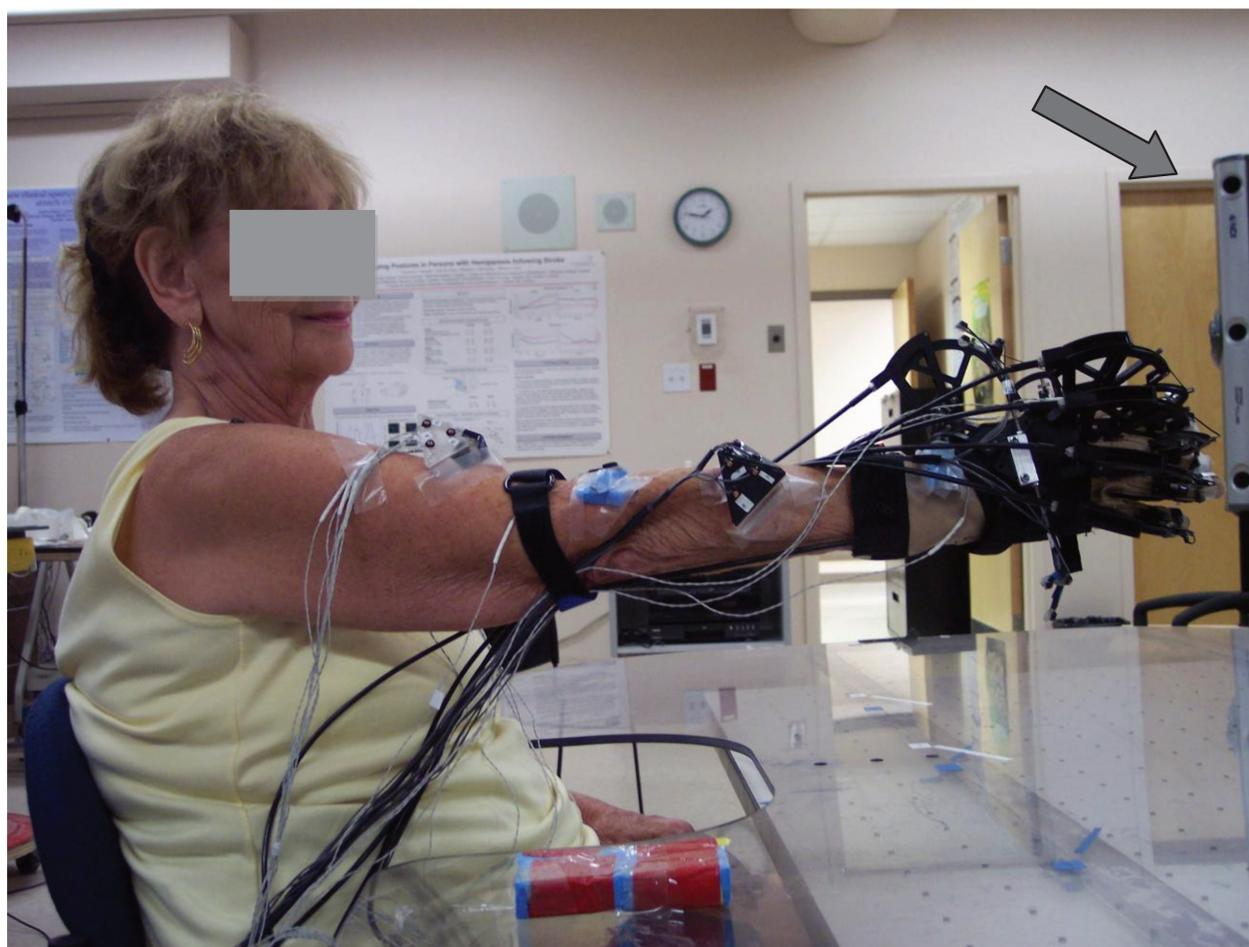
**Figura 4.16:** Sujeito saudável na “posição de referência” usada para a calibração dos ângulos a determinação dos cálculos angulares planos e rotacionais. Ao fundo, uma das barras do Optotrak Certus utilizada para capturar os dados cinemáticos (indicado pela seta).
