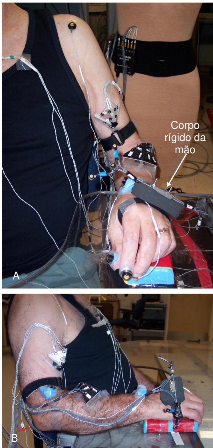
**Figura 4.7:** Vista anterior (A) e lateral (B) de dois participantes na posição inicial na condição ambiente físico sem o uso da luva - "sem luva" (*CyberGrasp* e *CyberGlove*), somente com o corpo rígido da mão.
