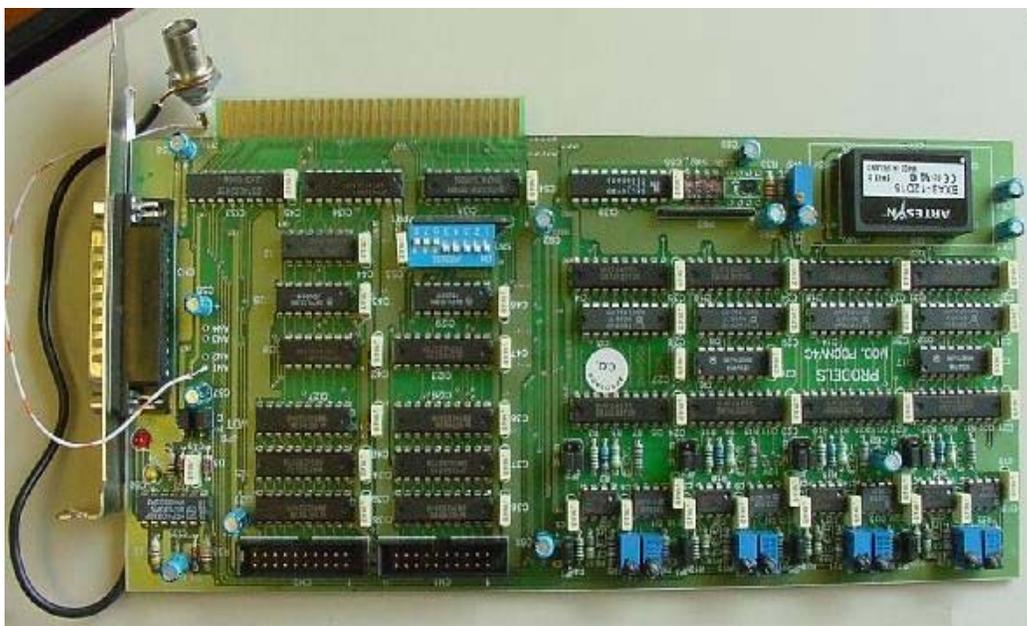
*Fig. 3.6. Estrutura da placa de conversão Digital-Analógica (placa D/A)*
