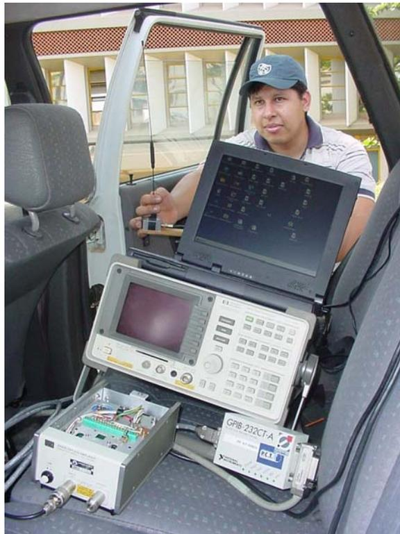
Fig. 4.5. Sistema receptor instalado dentro de uma unidade móvel, pronto para realizar medições de campo.
