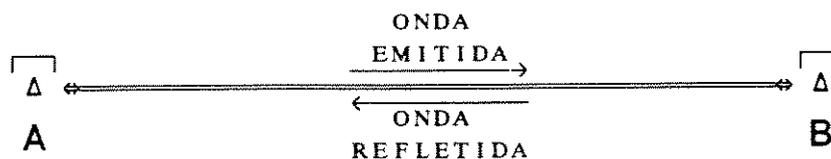
FIG. 2.1 - Sinal emitido pelo assinante 1 e refletido quando, ao chegar ao assinante 2, encontra uma impedância descasada.
