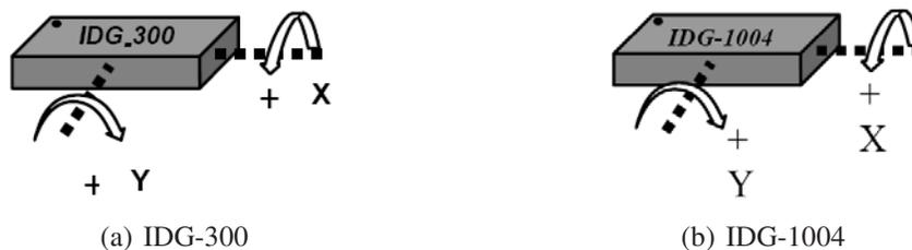
Figura 3.11: Orientação dos eixos de rotação dos giroscópios IDG-300/1004 [48] [47].
