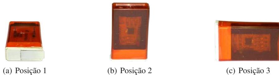
Figura 3.31: Posições para calibração do acelerômetro.
