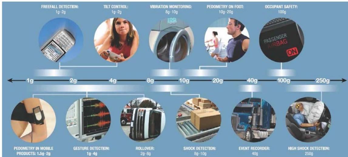
Figura 2.21: Aplicações dos acelerômetros segundo o range de operação [23].
