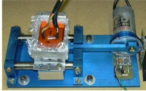
Figura 4.14: Plataforma de deslocamento com plástico com bolhas em baixo do sensor.
