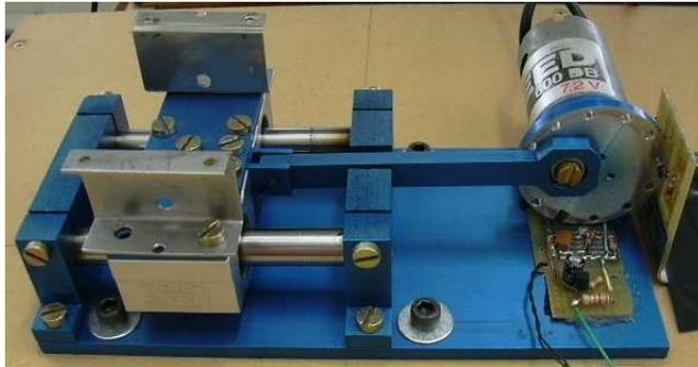
Figura 3.33: Mesa de deslocamento linear ou *Shaker*.
