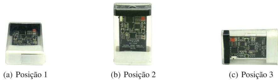
Figura 3.47: Posições para calibração da placa ZSTAR.
