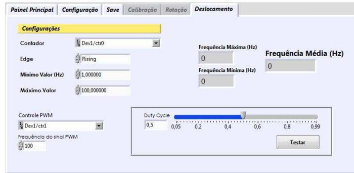
Figura 3.37: Imagem da aba deslocamento no painel frontal.
