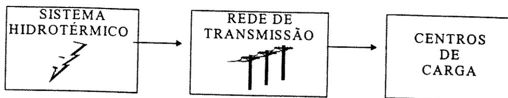
**Figura 2.1: Componentes do sistema elétrico**
