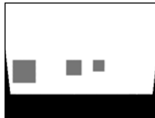
Fig. 2.27 - Imagens retificadas sob efeito da rotação em torno do eixo X.
