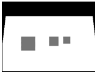
Fig. 2.27 - Imagens retificadas sob efeito da rotação em torno do eixo X.
