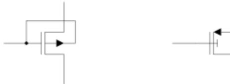
**Figura 23 – Transistor DTMOST tipo P: notação convencional e símbolo DTMOST**
