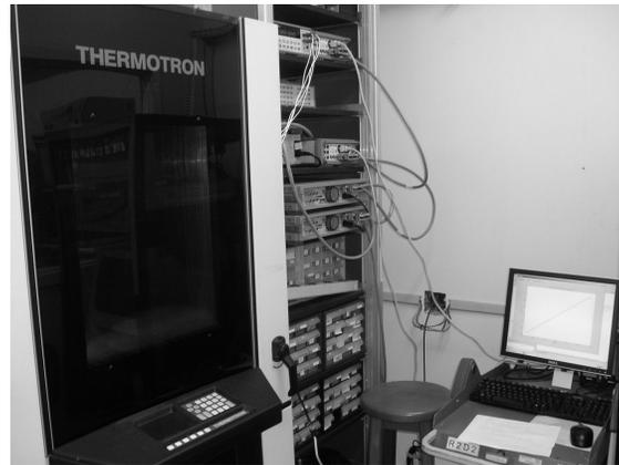
**Figura 68 – Foto da montagem para medições com câmara climática**
