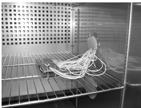
**Figura 66– Montagem dos CIs no interior da câmara climática**
