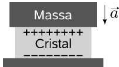
Fig. 3.2: Princípio de funcionamento dos acelerômetros piezelétricos (adaptado de [36]).
