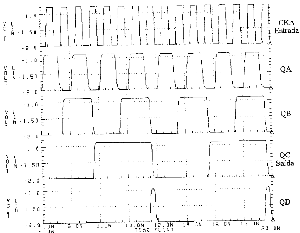
Figura A.8 – Divisão da frequência de clock por 8.
