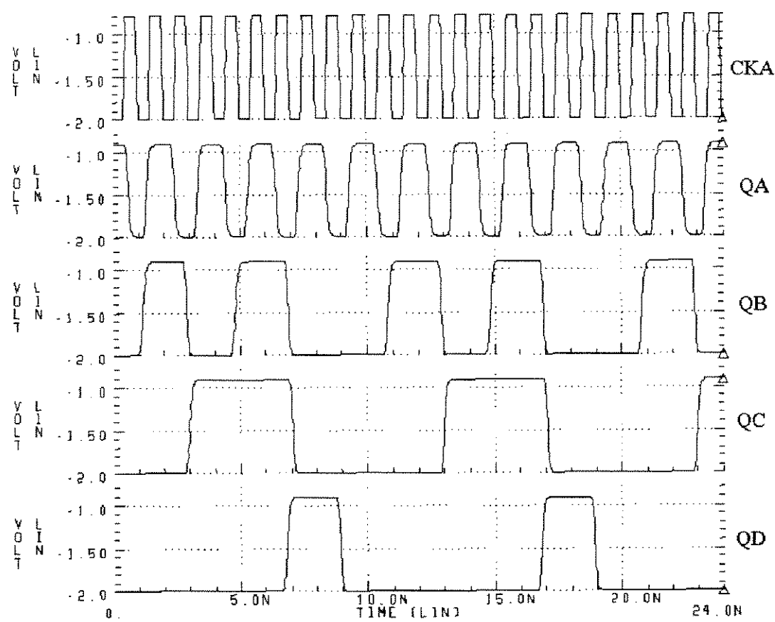
Figura 4.16 - Simulação final do 7490-like como contador de década.
