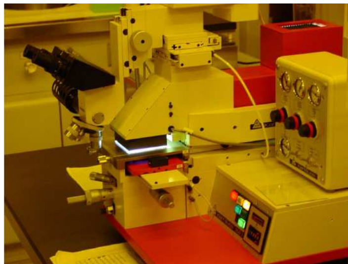
Figura 89 – Fotografia de foto-alinhadora de máscaras (CCS/UNICAMP).
